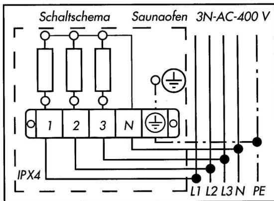
Der Anschlußplan für den Saunaofen ist auf der Innenseite der Ofenrückwand angebracht und entspricht nebenstehender Abbildung.
