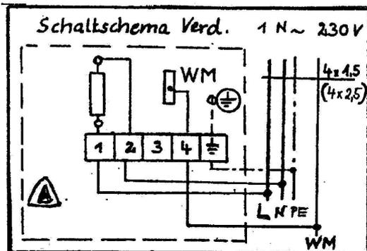
Der Anschluss für den Verdampfer des Saunaofens entspricht nebenstehender Abbildung.
