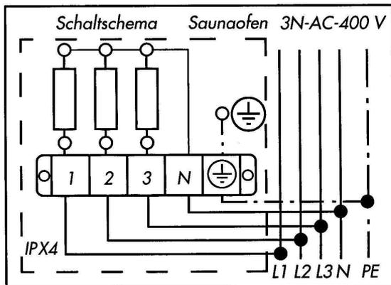
Der Anschlussplan für den Saunaofen ist auf der Innenseite der Ofenrückwand angebracht und entspricht nebenstehender Abb..
