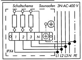
Der Anschlußplan für die Raumheizung des Saunaofens ist auf der Innenseite der Ofenrückwand angebracht und entspricht nebenstehender Abbildung.
