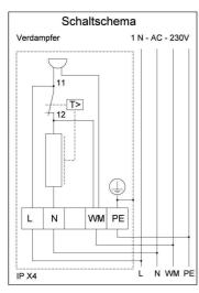
Der Anschluß für den Verdampfer des Saunaofens entspricht nebenstehender Abbildung.
