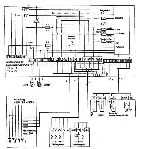
Wird die Anlage mit einem Steuergerät ohne Wassermangel-Schaltung betrieben, bleibt die Klemme "WM" im Steuergerät unbelegt!
